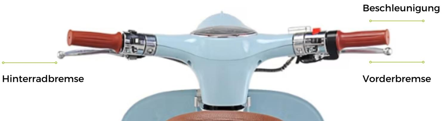
! Betätigen Sie beim Beschleunigen nicht die Bremsen. Lassen Sie immer erst den Handgriff los, bevor Sie die Bremsen betätigen.
